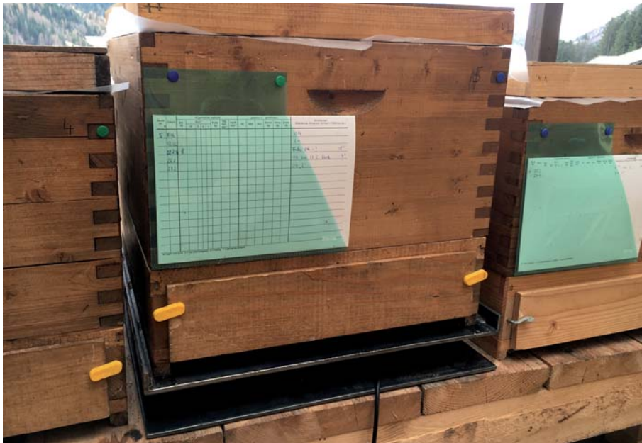
Bienestockwaage mittels SMS Übertragung und Stockkarte am Stand von Rud Christoph in Lana.
