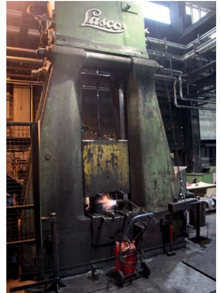
Alter Fallhammer zur Herstellung der Rohlinge [Bild: Werkgenossenschaft Stubai]
